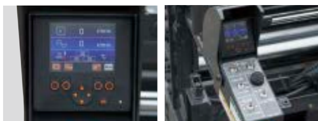
スクリーン操作ボックスのカラーサブモニター 集中コントロール部
