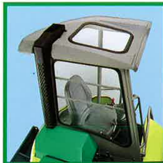
作業周辺環境に配慮した 上方排気のコーナーポストマフラー
