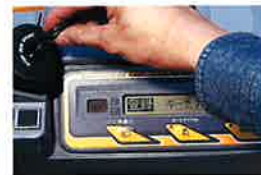
①登録キー(赤)を挿入し、表示切替ボタンを押す。 ②新しい個別キー(黒)を挿入
