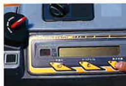
①登録キー(赤)を挿入し、表示切替ボタンを押す。 ②新しい個別キー(黒)を挿入
