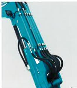
万一のホースの破裂時に、圧油がオペレータにかかるのを防ぐプロテクターホースカバー。
