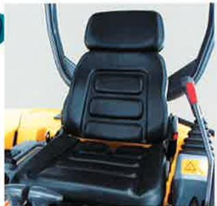
体重に合わせて調整できるサスペンションシートと、オペレータを守る巻き取り式シートベルトを採用。
