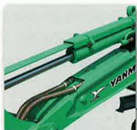
破損を防ぐ油圧ホースカバー
