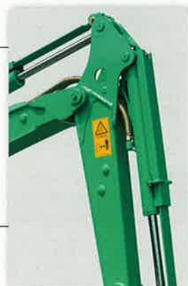
ロッド傷つきによる油漏れを 防止するシリンダガード
