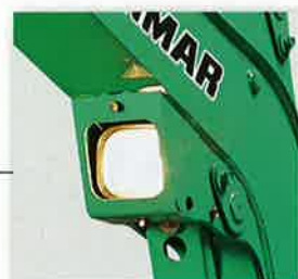
作業用ライトを破損の少ない ブーム下部にスッキリ内装
