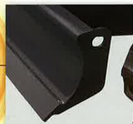
大型化され材質に特殊鋼を使い 耐久性を高めた ブレードカッティングエッジ
