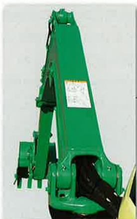
油圧ホースの損傷を防ぐため、 ブームに内装した外観ススキリの インナーブーム
