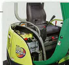
バッテリーチェックや給油がしやすい 大きく開く右ボンネット
