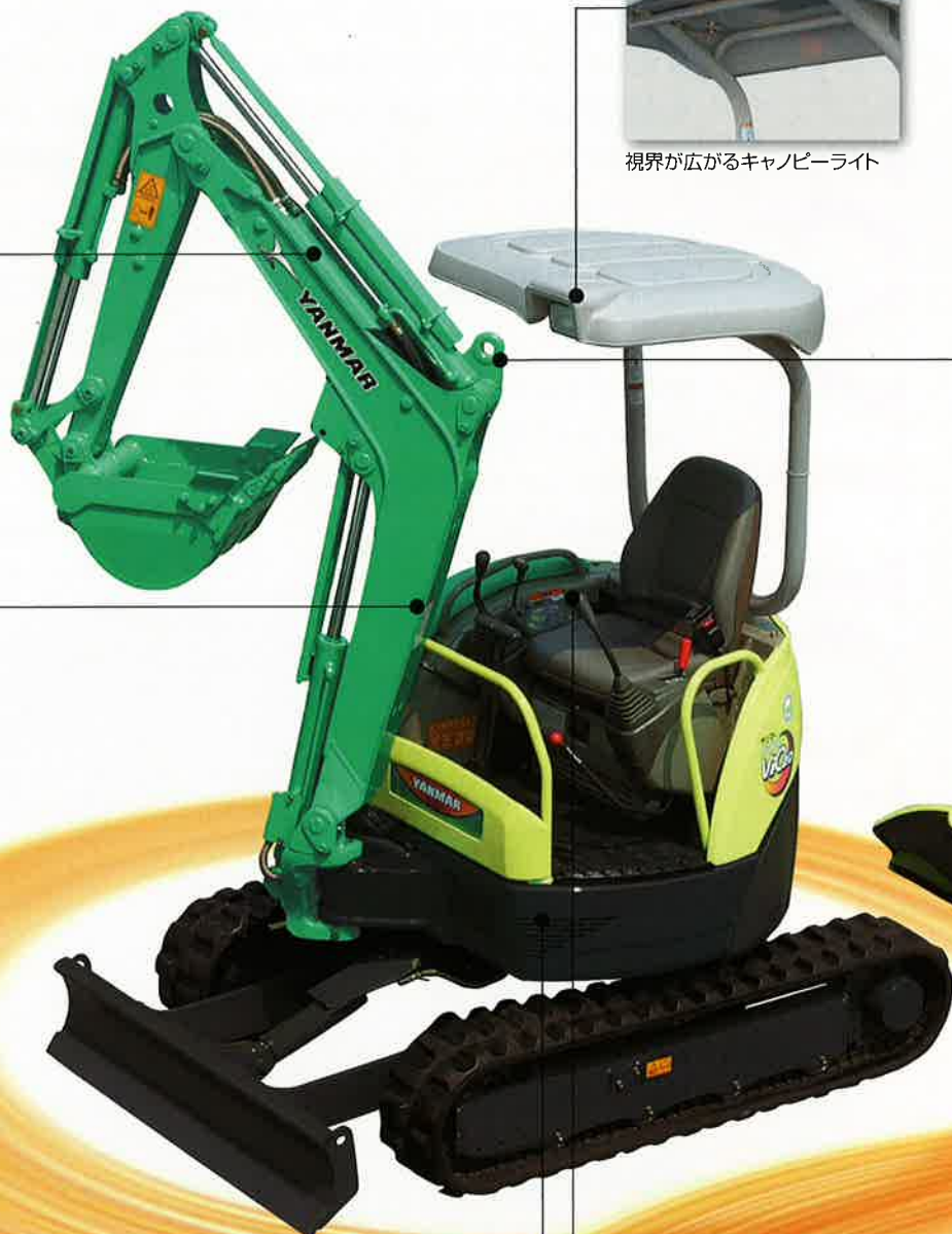
油圧ホースの損傷を防ぐため、 ブームに内装した外観ススキリの インナーブーム
