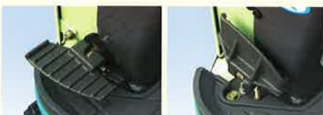
はね上げ格納式ペダル(走行2速ペダル)
