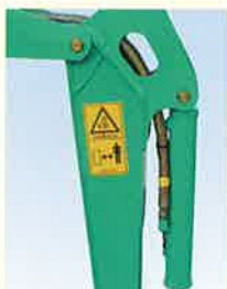
バケットシリンダー ホースのアーム内装化
