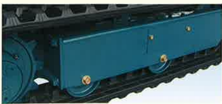
走行振動をやわらげる外ツパストラックローラ
