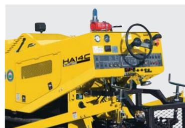
オペレータの手の届く範囲にすべての操作が可能な設計で、運転操作が一層容易になりました。また操向系油圧回路に、分・集流弁(コンバイナ)(実用新案登録済)を使用していますので、速度に拘わらず安定したステアリング性能が発揮されます。
