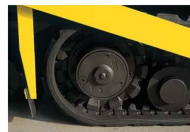
走行モータを2速モータ採用で作業時(低速)回送時(高速)の切替えが可能になりました。
