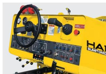
HST(静油圧トランスミッション)を採用、前後進レバー1本で車速をコントロールし、任意な速度が得られます。
