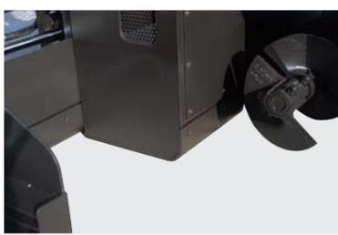
ボルトアップ式スクリードプレートを採用していますので取替えが容易です。なお底板は、高張力鋼板を採用しておりますので路盤材も施工可能。
