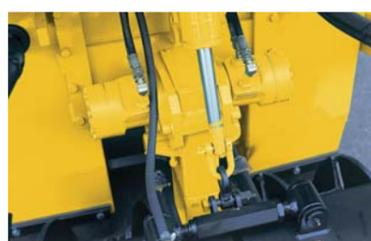
スプレッド装置は、スクリード上下に連動で、障害物や回送時、トラックへの積み込み時などの移動時にスクリュを傷めることなく安心です。
