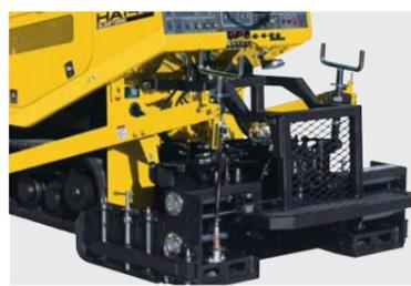
舗装幅、舗装厚、スクリード伸縮に左右されない仕上り性を保証するRV(リヤ変り変)構造です。
