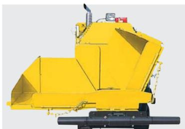
ホッパは2段階折畳式で、左右単独操作が可能。舗装現場に合わせて調整ができ、障害物も避けられ大変便利です。ホッパ容量は1.54tあり、2tダンプから4tダンプの接車が可能です。なお、プッシュしての施工はできません。
