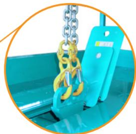
コンプレッサや発電機と同様の一点吊りフックで、トラックへの積み込みが簡単に行えます。
