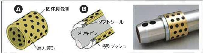
A ブッシュは、高力黄銅に埋め込まれた固体潤滑剤がブッシュの表面に層を形成し、金属同士の接触を防止。優れた潤滑状態が持続し、連結部の摩耗を抑えます。
