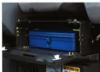
シート下に大型工具箱を設置
