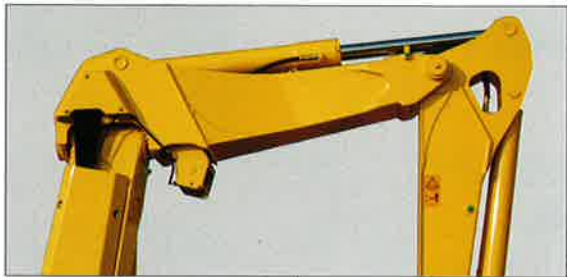
損傷しにくい boom背面アームシリンダー
