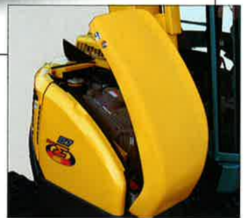
燃料給油口、バッテリーなどを 収納したサイドボンネット
