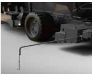
走行指針照明灯
