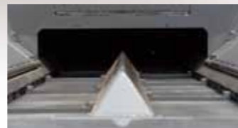
コンベヤ中央チェーンカバー
