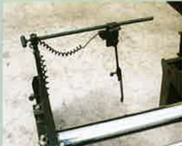
スクリュー合材フローコントローラ (スクリュー単独/コンベヤ運動)
